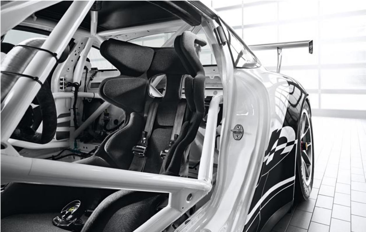
**Im Rahmen der Möglichkeiten:** Bei Überschlägen und Kollisionen schützt ein neu berechneter Überrollkäfig
